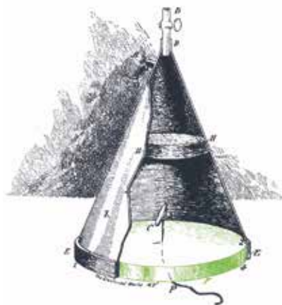
Fig. 2. De metalen ionenbuis van E.A. Woodward 5 . C kathode, X metalen buisomhulling die tevens als anode dient, F glazen basisplaat die de kathode isoleert (groen), P elektrische aansluiting van de kathode, H houten schijf die voorkomt dat de buis door het vacuüm implodeert, E messing ring die de basisplaat met de conus verbindt, D aansluiting van de afzuigpijp op de conus, B afzuigpijp die naar de vacuümpomp leidt.
