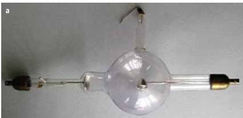
Fig. 6. De platina anode afscherming van Paul Villard in de buis van Victor Chabaud 17 . Fig. 6a. De ionenbuis. Fig. 6b. De afgeschermde anode.
