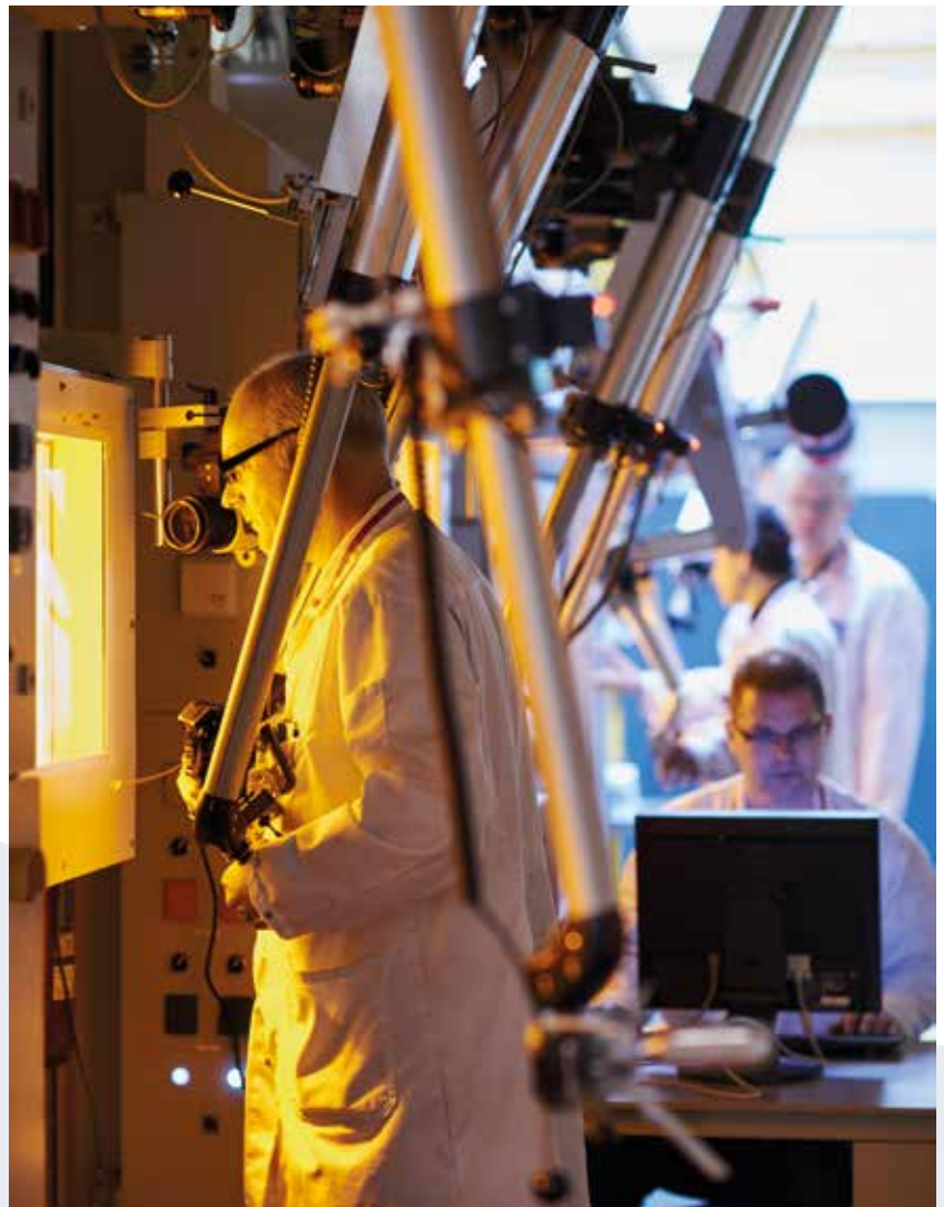
Figuur 4. Bediening van een hotcell in Petten t.b.v. productie van verschillende radionucliden (bron PALLAS).
