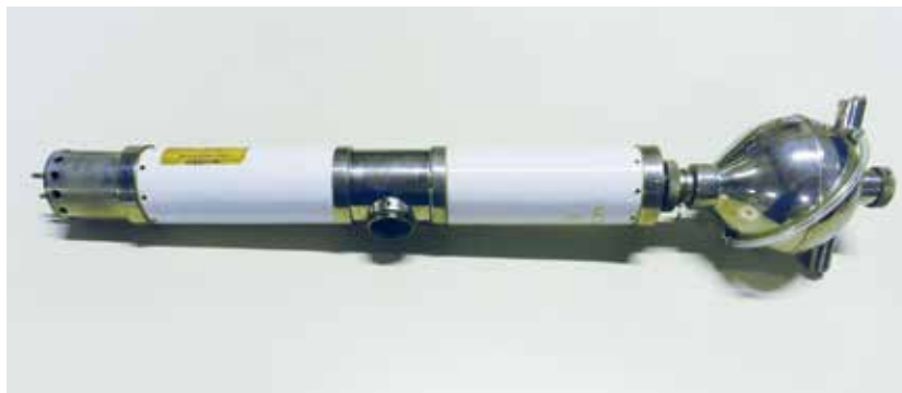
Figuur 2. Multix röntgenbuis van Siemens-Reiniger-Veifa in onze collectie. Deze buis heeft een mantel van keramiek.
