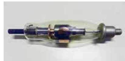
Figuur 4. De Phönix Radon NER10 röntgenbuis die in het mobiele röntgenapparaat Nanos werd toegepast en die zich in onze collectie bevindt.
