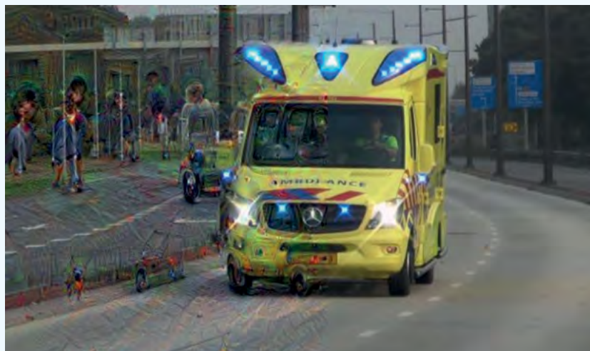
Figuur 2. Rechts de originele afbeelding en links aangepast zodat het netwerk met meer overtuiging iets herkent. Deze zogenaamde deep dream heeft voetgangers op de weg geplaatst. Dit laat zien dat het netwerk de foto logischer vindt als er voetgangers op straat lopen, maar ook dat het niet let op welke plek de voetgangers gezet worden. Als er meer patronen op willekeurige plekken te vinden zijn, heeft het netwerk meer vertrouwen iets te herkennen.
