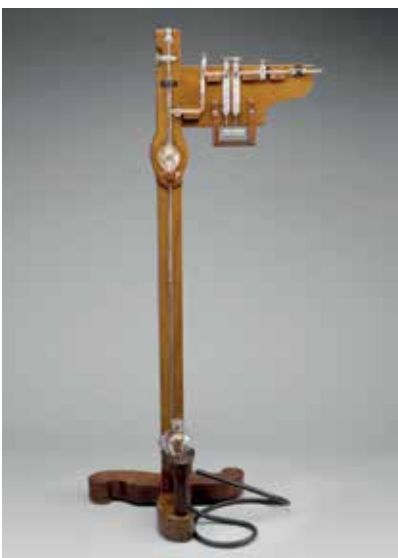
Fig. 5. De kwikpomp van Geissler in Teylers Museum. Dit apparaat werd gebruikt om röntgenbuizen vacuüm te trekken.
