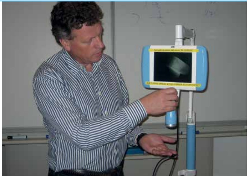
Prof. Ruud Verdaasdonk demonstreert de Vasculinator, waarbij met probe UV-straling wordt uitgezonden, waarmee bloedvaten op het scherm zichtbaar worden.
