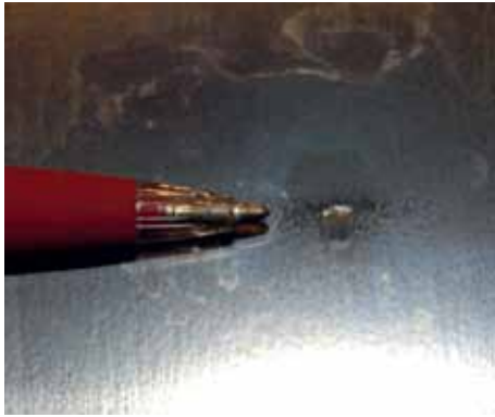
Onregelmatigheid zichtbaar op oppervlak van een wals die met punt van balpen wordt aangewezen
