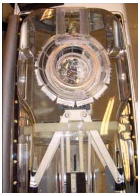
Figuur 3. HIFU design door Philips. De borst wordt geplaatst in de cup die geïntegreerd is in de MRI-tafel. Rondom de cup zijn meerdere transducers gebouwd. Deze produceren geluidsgolven die samenkomen op een bepaald punt midden in de borst, het 'focale punt'. Het systeem is recentelijk geïnstalleerd in het UMC Utrecht en de eerste onderzoeken starten binnenkort.
